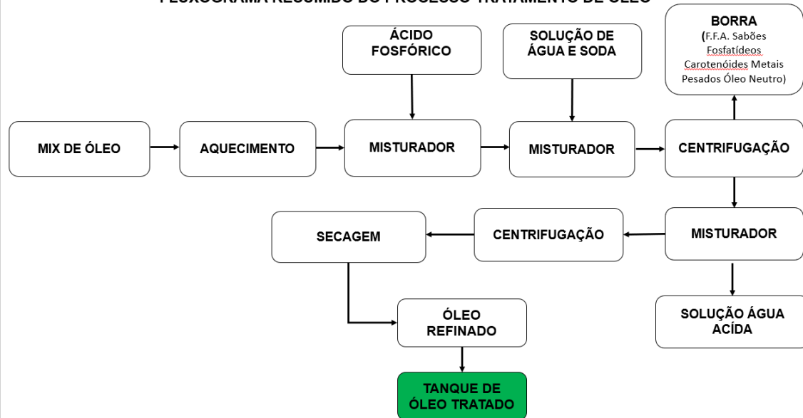
FLUXOGRAMA RESUMIDO DO PROCESSO TRATAMENTO DE ÓLEO
